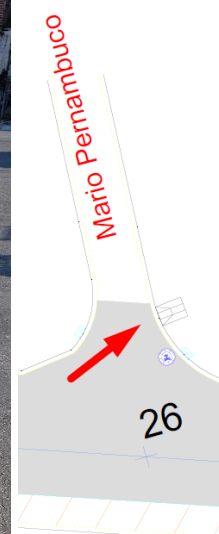
Imagem 03 – Vistoria 12/09/2024 – Rampa de acessibilidade Av. Min. Salgado Filho com a Rua Mario Pernambuco – Inclinações incorretas e sem distância mínima para raio de manobra.
