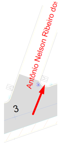
Imagem 07 – Vistoria 12/09/2024 – Rampa de acessibilidade Av. Min. Salgado Filho com a Rua Antônio Nelson Ribeiro dos Santos – Inclinações incorretas.
