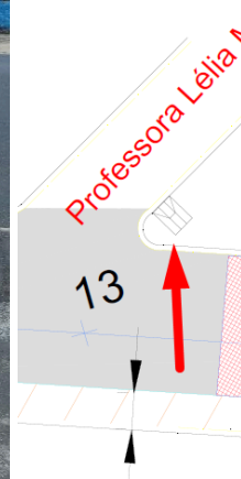
Imagem 05 – Vistoria 12/09/2024 – Rampa de acessibilidade Av. Min. Salgado Filho com a Rua Profª Léia Marcia Pasquim – – Inclinações incorretas, sem distância mínima para raio de manobra e obstáculos.
