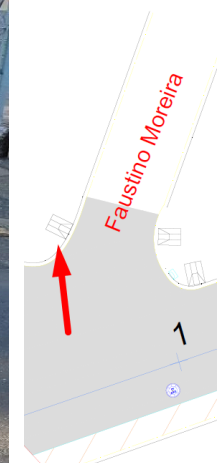
Imagem 10 – Vistoria 12/09/2024 – Rampa de acessibilidade Av. Min. Salgado Filho com a Rua Faustino Moreira – Inclinações incorretas, sem distância mínima para raio de manobra e obstáculos.
